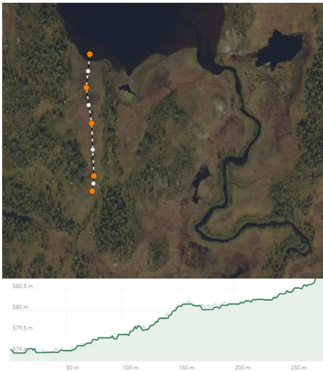
Figur 16. Høydeprofil fra Usmesjøen og sørover i myrområder. Ved 1 meter heving av Usmesjøen (fra 579 til ca 580 MOH) vil sørvestlige myr oversvømmes ca 150 - 200 meter sørover.
